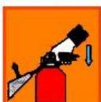
**Перевести раструб в удобное для оператора положение, подойти к очагу пожара на 2 м и нажать на рычаг**
