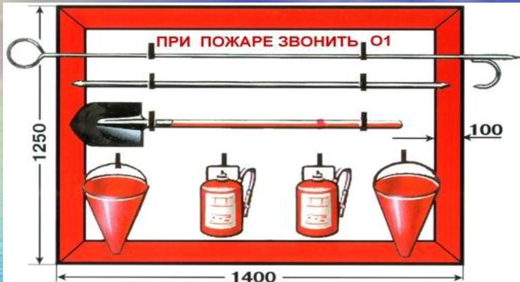
**ПРЕДНАЗНАЧЕН** для размещения первичных средств пожаротушения, немеханизированного инструмента и пожарного инвентаря в производственных и складских помещениях, не оборудованных противопожарным водопроводом и автоматическими установками пожаротушения, а также на территории предприятий, не имеющих наружного противопожарного водопровода, или при удалении зданий (сооружений), наружных технологических установок на расстояние более 100 м от наружных пожарных водосточников.
